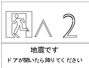
《地震時管制運転》
